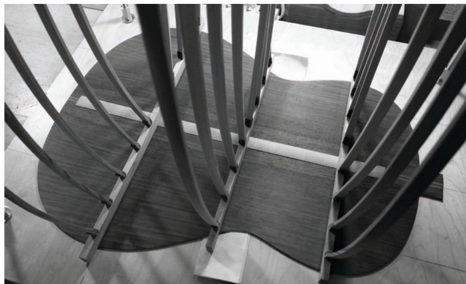
Przyklejanie belek do „pleców” gitary z wykorzystaniem systemu rozpórek.
