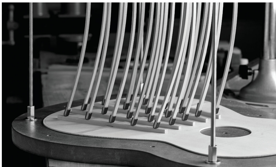
Przyklejanie tzw. żeberek do płyty rezonansowej z wykorzystaniem „solery” i systemu rozpórek.
