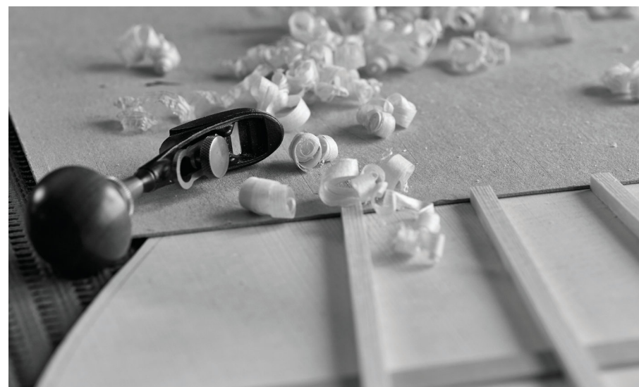
Kształtowanie ożebrowania płyty rezonansowej przy pomocy mini struga.
